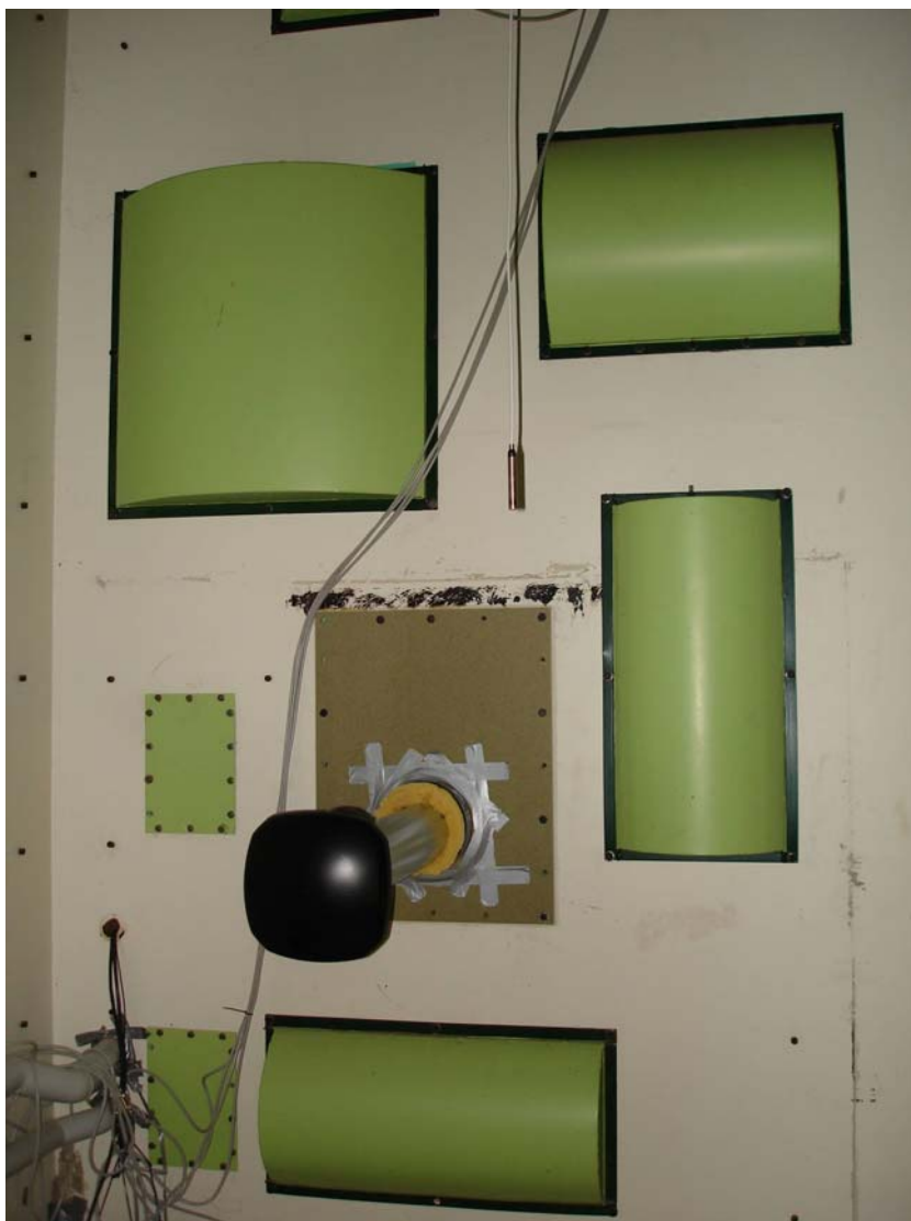
Figur 1 - Opstillingen i klangboksen hvor der måles lydeffektniveau med 6 mikrofoner
